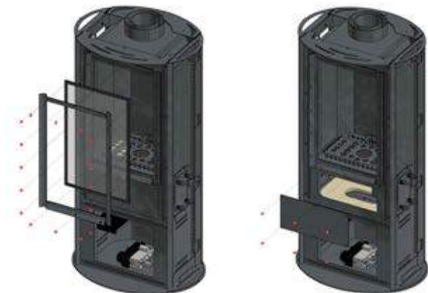
Rys. 11. Demontaż szyby wewnętrznej i rewizji w ogrzewaczu Koza AB GAZ
