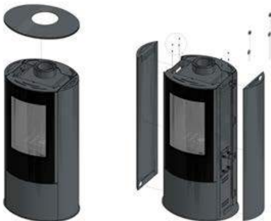
Rys. 8. Sposób demontaży płyty górnej i ścian bocznych w ogrzewaczu Koza AB GAZ
