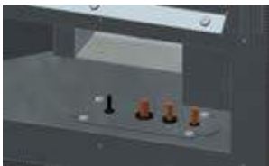
Rys. 7. Sposób wyprowadzenia i uszczelnienia przewodu kapilary, przewodu iskrownika, rurki palnika głównego i rurki palnika kontrolnego w ogrzewaczu Koza AB GAZ.
