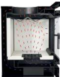
Rys. 1. Kasetta ARKE – obieg powietrza we wkładzie kominkowym ARKE
