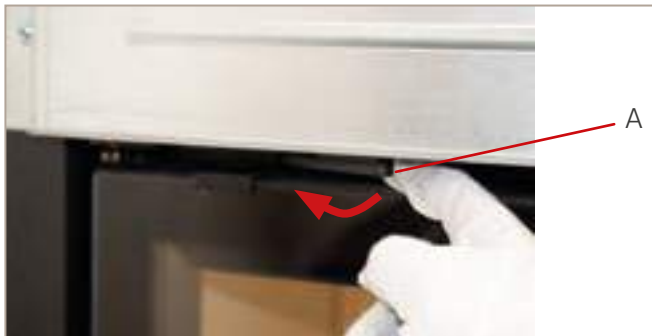
Abb. 47: „Schließzunge links“ öffnen
