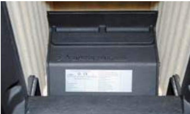
Abb. 30: Typenschild auf Luftkanal vorn im Feuerraum
